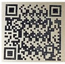
ピコ秒レーザー使用 アルミのブラックマーキング加工
